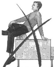
Tímto způsobem užívání dochází k deformaci pěnových výplní opěráků sedací soupravy, k nadměrnému zatěžování potahového materiálu a rovněž může dojít k mechanickému poškození samotného rámu či kování
